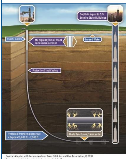
Llega un equipo de producción y perfora una profundidad de 7,000 y 8,000 pies. La parte horizontal del pozo puede extenderse más de dos millas. A continuación, se instalan capas adicionales de tubería protectora de revestimiento de acero y cemento.
