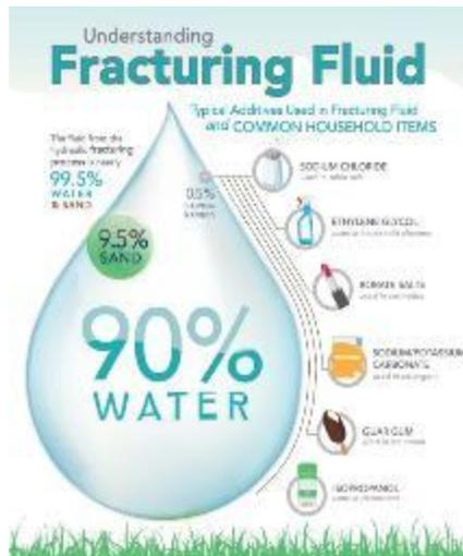
**Fractura hidráulica:** Tecnología segura y de alta ingeniería desarrollada en la década de 1940. Se bombea fluido a presión a más de una milla por debajo de la superficie de la tierra para crear fracturas muy finas en las rocas.
