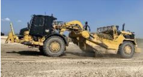
El equipo de construcción estándar prepara el emplazamiento del pozo. Se puede instalar una pared para reducir o minimizar el ruido y la luz durante la fase de desarrollo.
