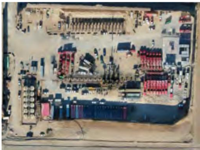
•Vista aérea de un sitio de múltiples pozos con equipo de fracturación hidráulica instalado dentro de una pared de sonido
